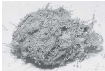
アスベスト(青石綿・クロシロイト)
