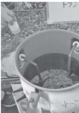
トランスの絶縁油を採取(左)、PCBの濃度測定を容易にするため、検査を妨害する物質を取り除く(右)。
