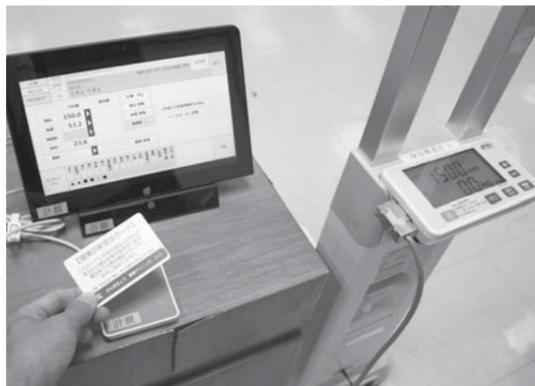
身長体重計に接続されたタブレットとICカードと読取装置
