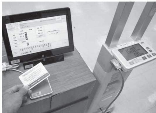
身長体重計に接続されたタブレットとICカードと読取装置
