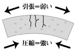
ひびが発生する仕組みと、実際に発生してしまったコンクリートひび
