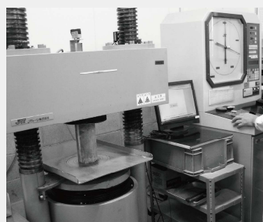
コンクリートの圧縮強度試験
