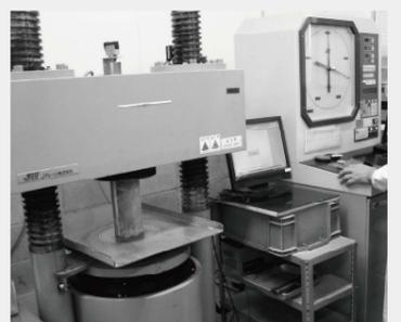
コンクリートの圧縮強度試験
