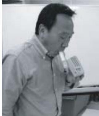
スモーカーライザー使用例。息を吹き込むだけで、呼吸中の一酸化炭素濃度が測定できる
