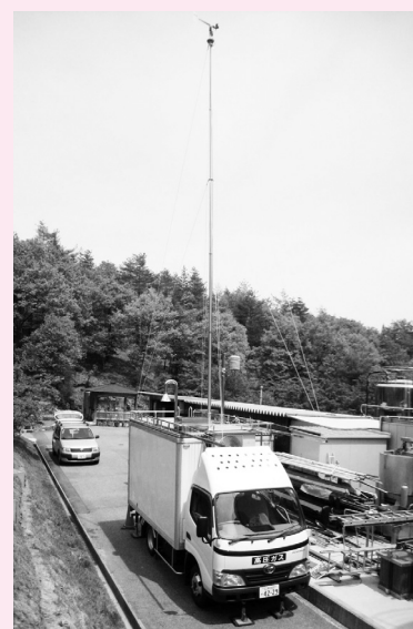
屋根に風向風速計を設置した大気測定車
