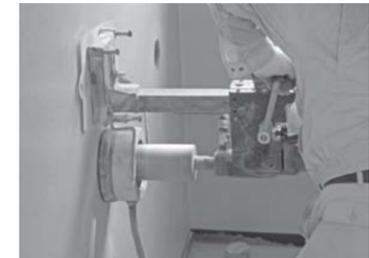
利に含まれる特定成分が膨張し、ひび割れが発生すること、鉄筋のさび・腐食、塩害等により、コンクリートも劣化を起し、耐久性が低下しているコンクリートの性状を直接確認すること
