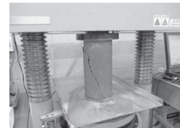
が出来ます。この検査結果は、建物の劣化診断や補強工事を行う際に活用され、建物の延命化・耐震化にも役立てられています。
