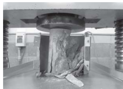
砕けた供試体と飛散防止カバー(圧縮試験)
