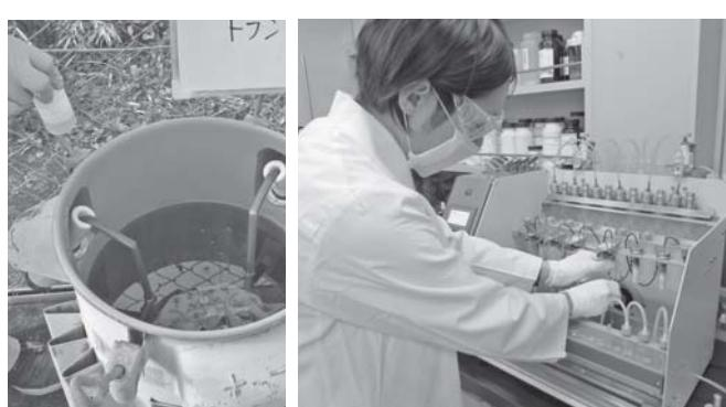
トランスの絶縁油を採取(左)、PCBの濃度測定を容易にするため、検査を妨害する物質を取り除く(右)。
