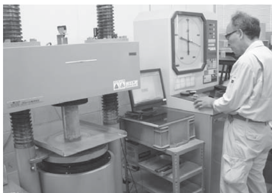
コンクリート圧縮試験(上) 平面度測定(右)の様子
