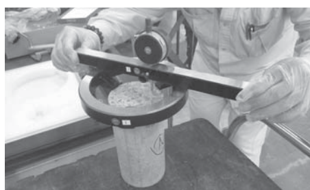
コンクリート圧縮試験(上) 平面度測定(右)の様子
