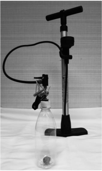
ヒートポンプとは、空気に圧力をかけたり減らしたりすることで空気の温度を上げ下げする仕組みのことで、
