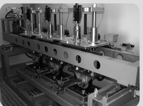
舗装のわだち掘れをシュミレーションする三連式ホイールトラック試験機
