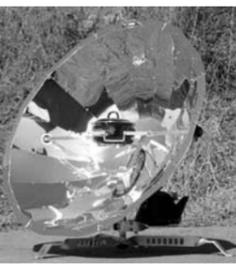
アルミ製パラボラの直径は八十センチ。中央の鍋置きに太陽熱を集める。
