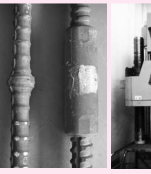
鉄筋のつなぎ部(左)、つなぎ部が母材部と同等の性能を有しているかを試験する装置、約200トの力で引っ張ることが可能(右)
