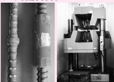
鉄筋のつなぎ部（左）、つなぎ部が母材部と同等の性能を有しているかを試験する装置、約200トンの力で引っ張ることが可能（右）
