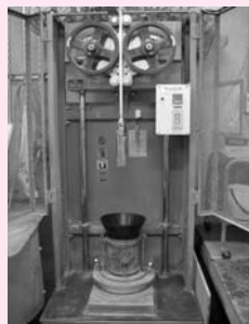
突固め装置(左)、CBR試験状況(右)
