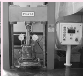
突固め装置(左)、CBR試験状況(右)
